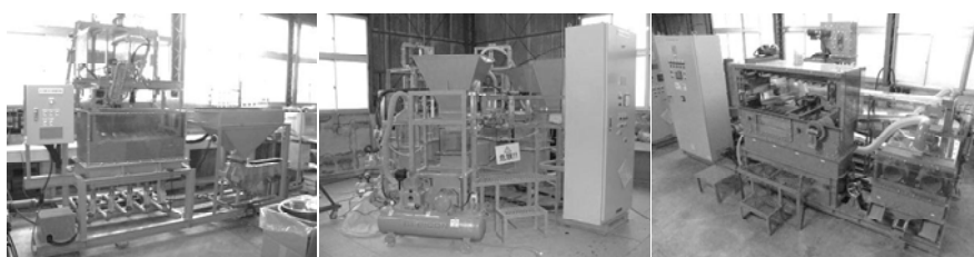
図2 浮き沈みしたものを取り出すことが可能な分離装置
