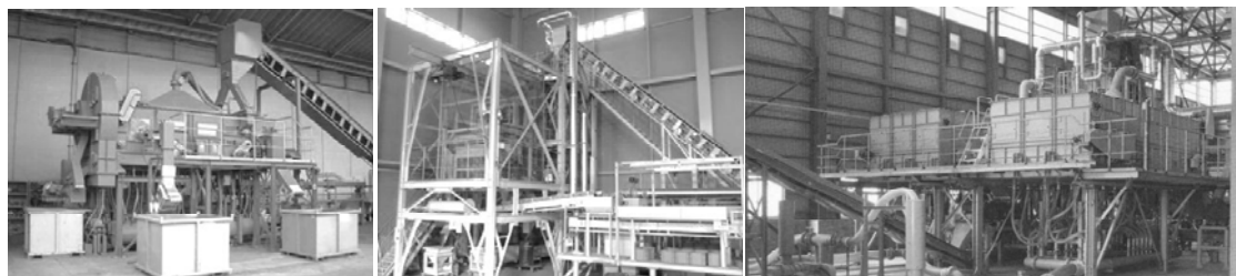
図3 実用化された乾式比重分離装置
