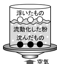
図1 固気流動層内でのものの浮き沈み
