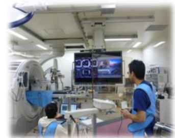
試作機によるファントムへの遠隔穿刺実験
